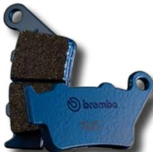
**+ SD – Sinter Off-Road.** Gute Bremswirkung und Stabilität unter allen Einsatzbedingungen. Hohe Verschleißfestigkeit auch bei Einsatz im Schlamm. Weniger aggressiv als SX, daher besser dosierbar.
